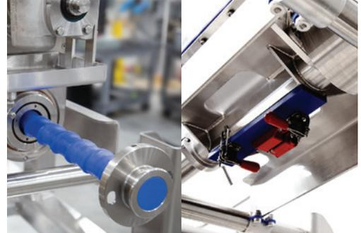
Capacidad de extraer el eje de mezcla y el tubo de transferencia sin herramientas. El tapón de drenaje Delrin simplifica los cambios de producto.
