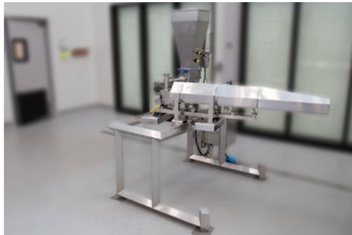
Conjunto de bastidor de montaje de dosificador de polvo/placa alimentadora con tubo de agua sobre construcción de diamante.
