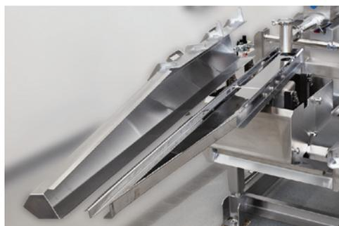
Лоток косой обрезки для оптимального покрытия.
