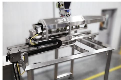
Дополнительно, система монтажа на перевозной раме без применения инструментов для упрощения санитарной обработки.
