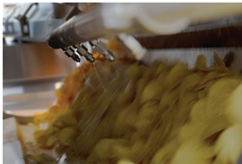
A aplicação de pulverização sem ar reduz o excesso de pulverização, garantindo a precisão da taxa de aplicação de óleo.
