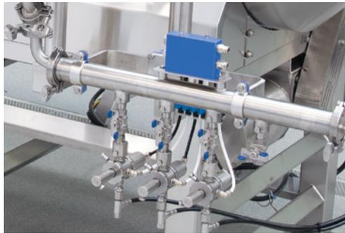
Bombas de produto de deslocamento positivo com configurações de micrômetro ajustáveis.
