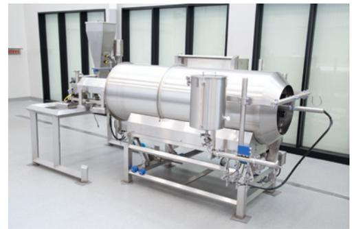
O aplicador de pulverização de óleo por pulsos MS-I como parte do sistema de revestimento de duas fases.
