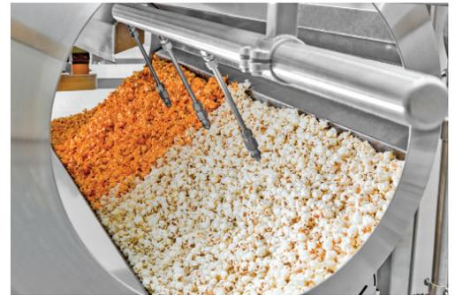
Barra de pulverização de bico remoto com bicos de gatilho autoajustáveis. Obtenha uma aplicação de pulverização direcionada precisa quando usada em um tambor de revestimento.
