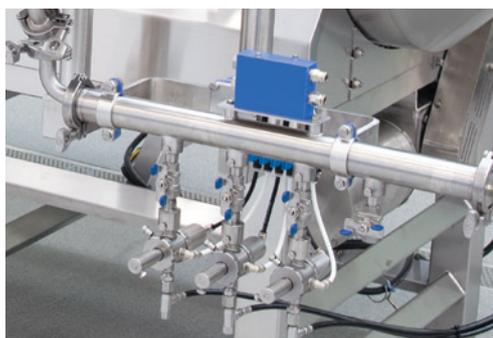
Объемные насосы с регулируемыми настройками микрометров.
