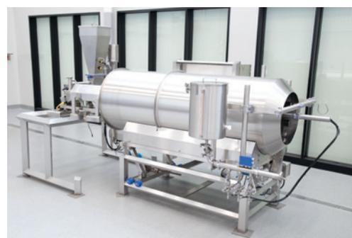
Импульсный распылитель масла MS-I является частью двухступенчатой системы панировки.
