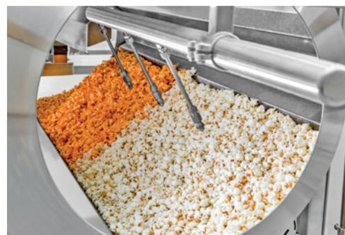
Дистанционный распылитель с саморегулирующимися тарельчатыми форсунками. Точное целевое распыление в барабане нанесения покрытия.
