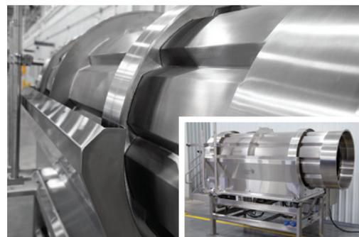
Дополнительный вариант конструкции барабана с одинарной стенкой для максимального упрощения санитарной обработки.
