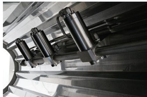
В наличии аппликаторы для подачи суспензии и непрерывного распыления масла.
