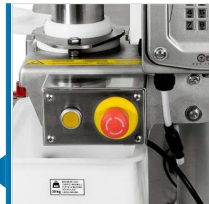
La serie THS/PLMS21 se ha diseñado para detección de contaminantes metálicos en productos transportados por tuberías, especialmente carne.
