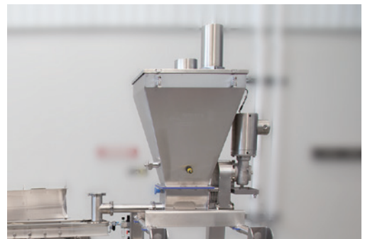
Conjunto de funil e tampa adaptável, compatível com uma variedade de opções de recarga mecânica ou pneumática.
